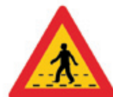
(K - 15) Κίνδυνος λόγω διάβασης πεζών.
