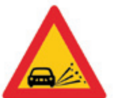
(K - 13) Επικίνδυνη εκτίναξη χαλίκων, (ασύνδετο αμμοχάλικο).
